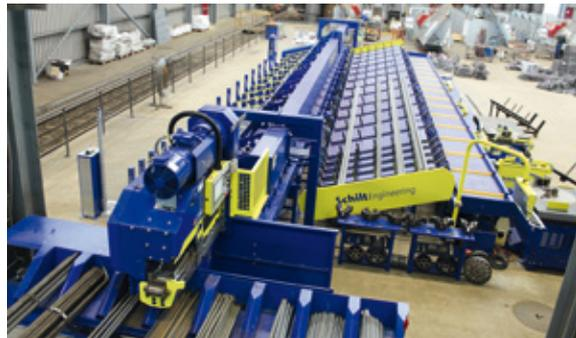
^ Verwendung eines Kettenmagazins für die optimale Nutzung der vorhandenen Lagerfläche.
