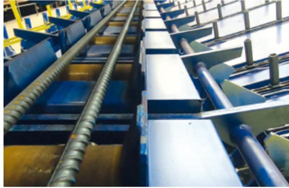
^ Nach dem Schnitt werden die Stäbe auf den Verteilerrollgang übergeben.
