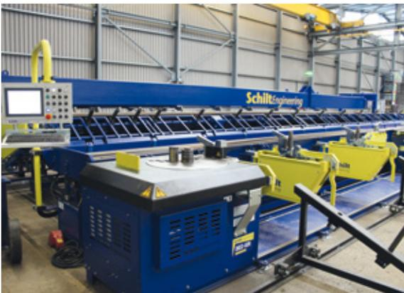
^ Ausführung der BPL40-ST mit integrierter Doppelbiegeanlage DBS3-60N.
